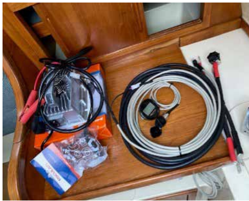
Sähkösisämoottorin akkulaturi 24v 20A ja kaapeleita
