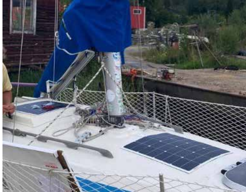
S/y Aulikki ja aurinkopaneelit SUNBEAM system Tough 58W Flush asennettuna kannelle
