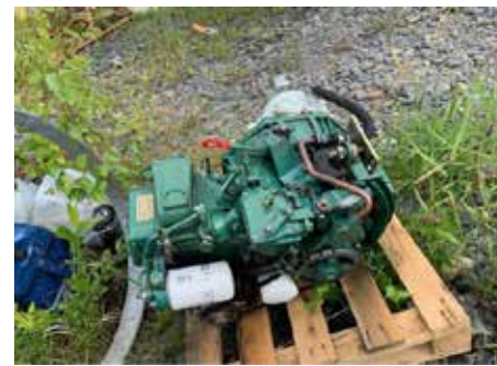
Vanha sisämoottori Volvo Penta 2001, jonka paikalle veneeseen asennettiin uusi sähkösisämoottori
